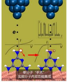
利用单分子选键化学操纵,实现了对单分子电子输运 性质的调控
